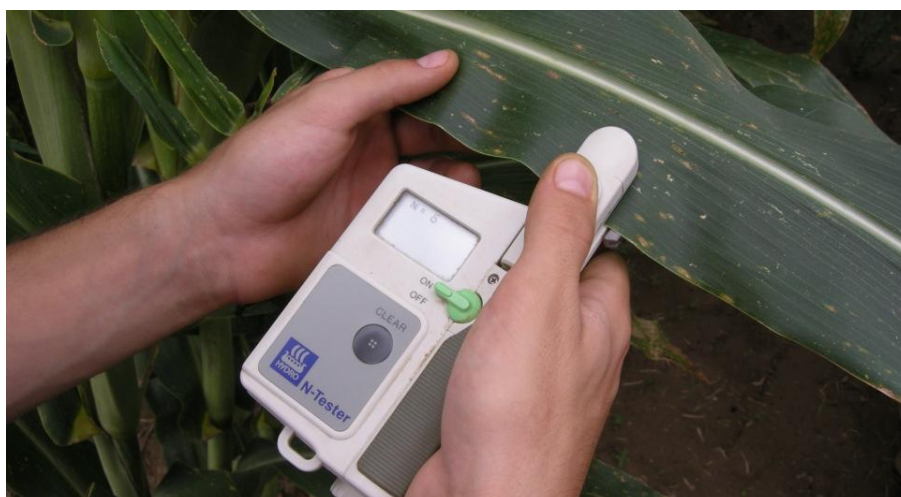
Figura 4.- Sensor óptico N-Tester, para la valoración del estado nutricional del cultivo, del ensayo 'Evaluación de la eficacia del fertilizante SuperNitro en el cultivo de maíz' realizado la campaña 2015 en Canet de la Tallada, Baix Empordà.
