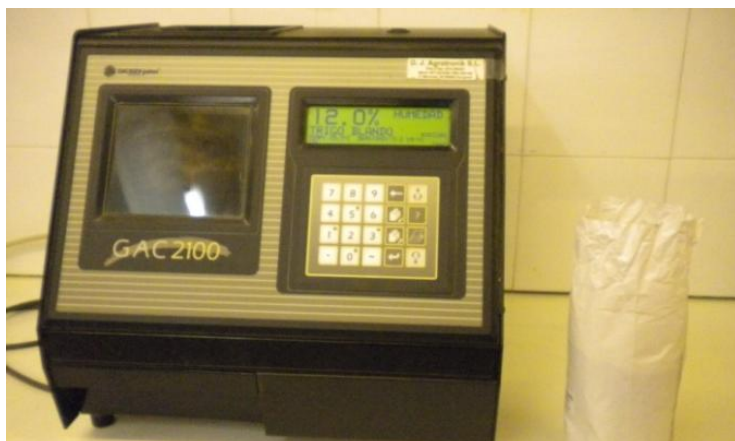
Figura 6.- Equipo de medición de la calidad del grano recolectado, del ensayo 'Evaluación de la eficacia del fertilizante SuperNitro en el cultivo de maíz' realizado la campaña 2015 en Canet de la Tallada, Baix Empordà.
